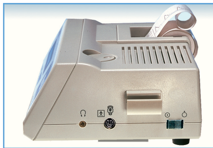
Seitenansicht mit Sondenhalter, Signal-Ein-/Ausgang, und Ein-/Aus-Schalter
