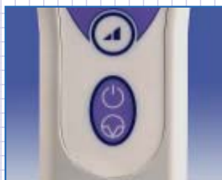
Folientastatur für Lautstärke, Speicher und Ein/Ausschalter
