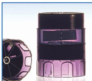
Mehrwertturbine zum Spirometer Spirolab III
