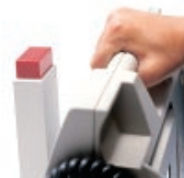
Der Defi-Monitor ist mit einem Griff aus der Ladestation zu entriegeln
